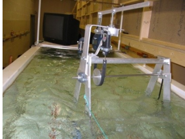
Líkan í prófunarkeri. Efsti hluti ramma og mælubúnaður stendur uppúr. Straumhraði um 0,5m/sek
