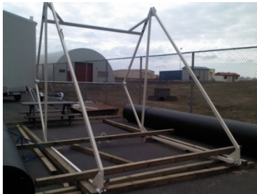
Flekinn í smíðum. Lyftigrind í reistri stöðu, flotörin til hliðar. Vantar hverfil, gálga, skýli, pall o.fl.
