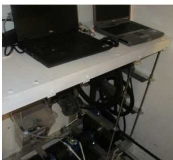
Séð inn í mælahús á prófunarflekanum Afl kemur inn á keðju neðst t.h. og er mælt með átaksmælinum fyrir miðju neðst á mynd. Sjá má gírurarbúnað til að auka snúningshraða svo unnt sé að keyra inn á alternator. Efst eru tvær tölvur; önnur tengd átaksmælinum en hin straumhraðamæli. Með þeim er fylgst með niðurstöðum og þær skráðar.
